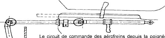
Le circuit de commande des aérofreins depuis la poignée jusqu'au bras d'aérofreins du fuselage est représenté ci-contre. Un contrôle visuel minutieux de toutes les parties soudées et en particulier des parties encerclées doit être effectué, si besoin, à l'aide d'un miroir et d'une lampe et après nettoyage, afin d'y déceler un éventuel début de crique.
