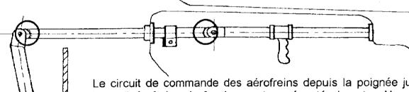
Le circuit de commande des aérofreins depuis la poignée jusqu'au bras d'aérofreins du fuselage est représenté ci-contre. Un contrôle visuel minutieux de toutes les parties soudées et en particulier des parties encerclées doit être effectué, si besoin, à l'aide d'un miroir et d'une lampe et après nettoyage, afin d'y déceler un éventuel début de crique.
